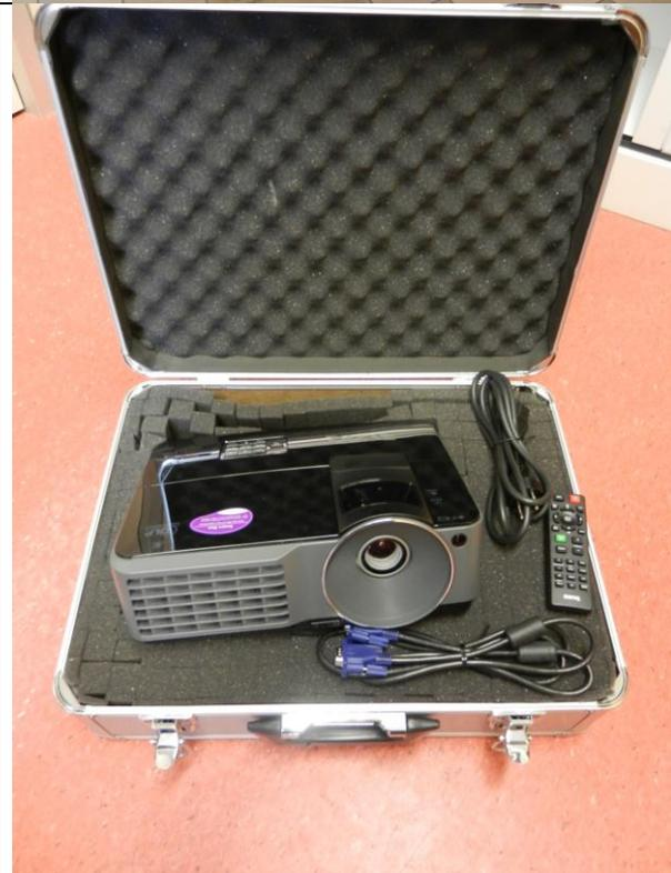
Beamer mit USB,VGA und HDMI - Anschluss
